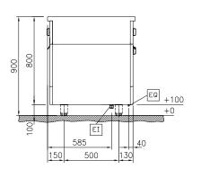
Electrical inlet (power) EQ **Equipotential screw**
